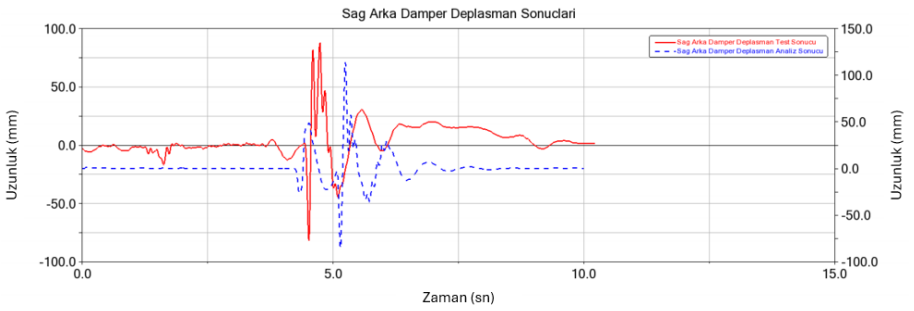
Şekil 15: 30 km/h Tümsek Analizi Sağ Arka Damper Dikey Deplasman Değişimi
