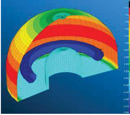
Şekil 23. Patran'da Toplam Işınım Isı Akısının Yarı Model Üzerinden İncelenmesi
