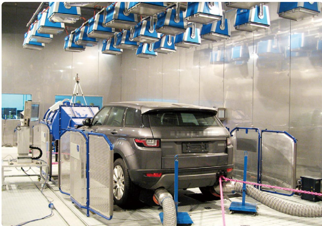
满足中国，欧盟和美国的性能和排放标准，可以进行不同温湿度条件下的浸车测试,冷启动测试,除霜和除雾性能测试；
