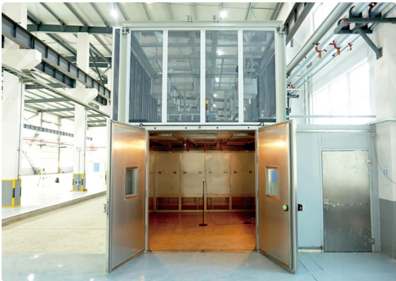
步入式环境模拟试验仓配合MASTTABLE（多轴液压振动台）MAST系统结合带红外模拟的环境仓可以模拟汽车零部件在极端温湿度以及振动环境下的性能。
