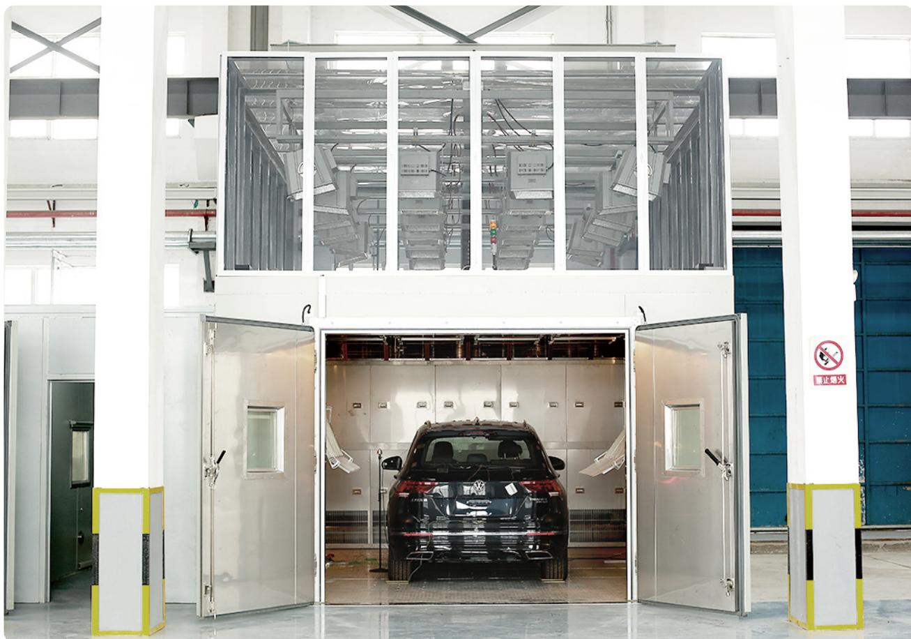
全光谱阳光模拟试验室符合DIN75220,宝马标准PR306.5以及奥迪标准VDA230-219
