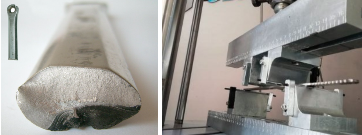
Şekil 6. Parçanın Yorulma Kusuru ve Mekanik Test
