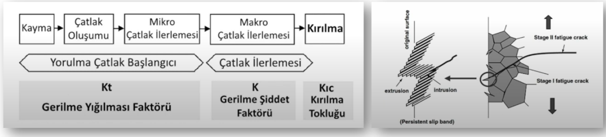
Şekil 3. Çatlak Oluşma Süreci
