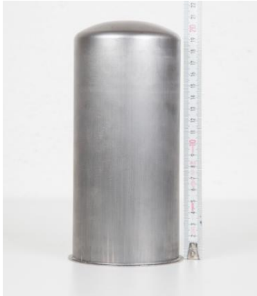
Şekil 1. Üç çekmede üretilen yağ filtresi gövdesi
