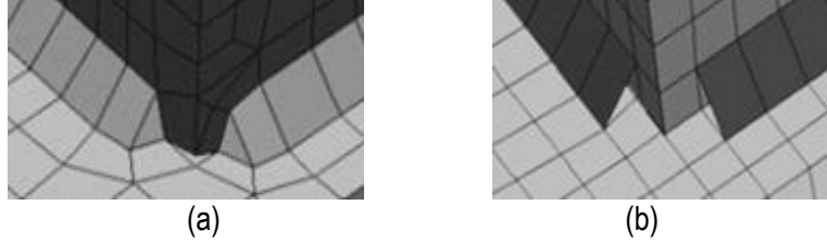
Figür 5: Kaynak uçlarının basitleştirilmiş modellemesi. Yaklaşım (b) yeterlidir.
