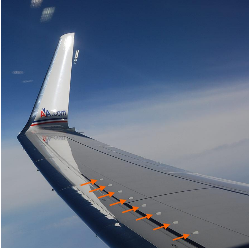
Şekil 6 Uçak kanadı üzerindeki çalkantı yaratıcılar (vortex generator) [3]
