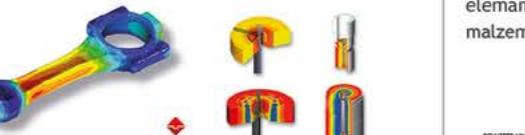
Simufact-Forming; Metal şekillendirme prosesi simülle edilebilir. Örnek olarak ekstrüzyon, çekme, basma, bükmeye, kapalı veya açık kalıpta dövme, haddeleme ve orbital şekillendirme verilebilir. Bu analizlerde mekanik, hidrolik, eksantrik ve vidası presler kullanılabilir.
